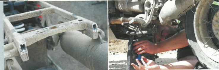
Opravy se nevyhly ani motocyklům. Dole prasklý podsedlový rám.
