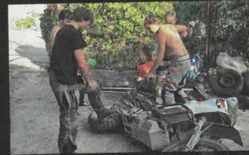
Odpojit elektriku, rozebrat předek a zadní část srovnat za pomoci krumpáče a lešenářské roury. To půjde.
